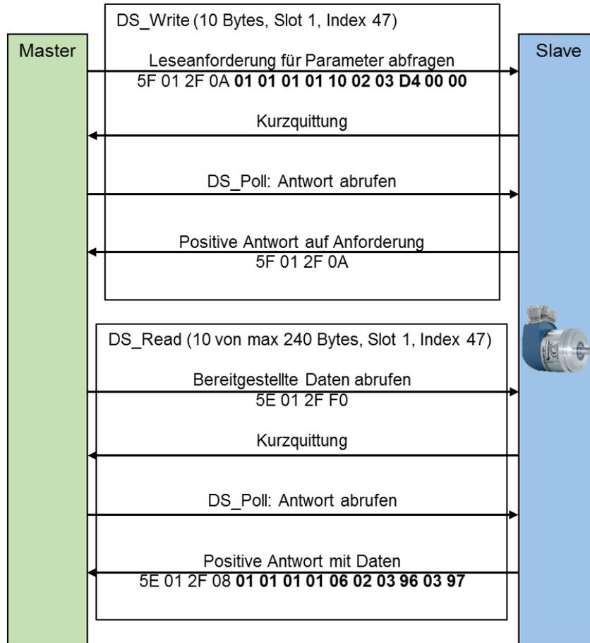
Figure 6.4: Reading parameters - PNU 980
